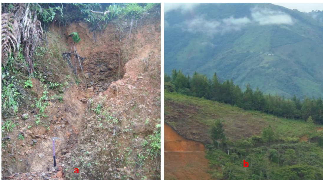
Foto 1. a) perfil de meteorización y suelo en vertientes. b) perfil de meteorización y suelos en el filo por donde corre la vía.
